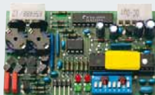
Indukciós hurok-kiértékelő Felpattintható 1- vagy 2-csatornás panel, alkalmas két különálló indukciós hurokhoz, szállítás hurokkábel nélkül.
