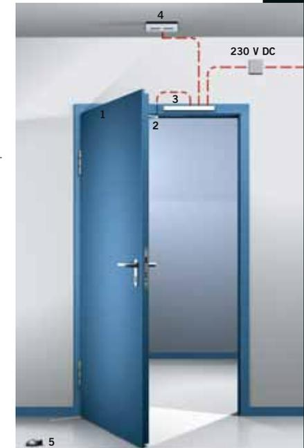
**Anwendungsbeispiel:** Feststellanlage an einer Feuer- und Rauchschutztür, bestehend aus Türschließer DORMA ITS 96 (1), Gleitschiene DORMA G 96 EMF (2), Rauchmeldezentrale DORMA RMZ (3) als Sturzmelder sowie je 1 Rauchmelder DORMA RM (4) als Deckenmelder auf beiden Seiten der Tür, Türstopper OGRO TZ 5000 (5)
