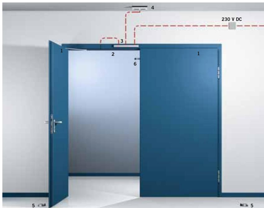
**Anwendungsbeispiel:** Feststellanlage an einer 2-flügeligen Tür, bestehend aus 2 Türschließern DORMA ITS 96 (1), Gang- und Standflügel-Gleitschiene DORMA G 96 G-SR-EMF (2) mit Schubstangen-Klemmsystem, Rauchmeldezentrale DORMA RMZ im Contur Design (3) als Sturzmelder sowie je 1 Rauchmelder DORMA RM im Contur Design (4) als Deckenmelder auf beiden Seiten der Tür, 2 Türstopper OGRO TZ 5000 (5), Mitnehmerklappe MK 397 (6)
